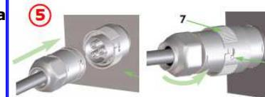
Enchufar ambas partes del conector. Girar el anillo (7) hasta que las trabas se introduzcan en la ranura de acoplamiento.
