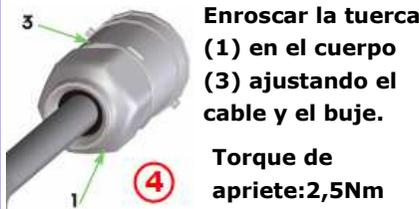
Enroscar la tuerca (1) en el cuerpo (3) ajustando el cable y el buje.
